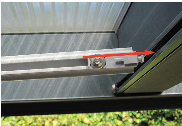
5.) Dann die Seite mit dem feststehenden Gleiter (kurz) in das gegenüberliegende Längsprofil klipsen. Das Klettprofil schwenkt beim Loslassen 90° nach unten in die richtige Position.
